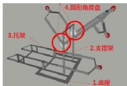
图1 新型可调式布朗氏架示意图
