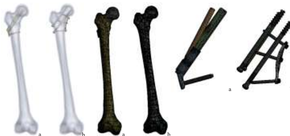
图1 模型分组:股骨颈系统组(a);3枚空心钉加内侧钢板组(b)
