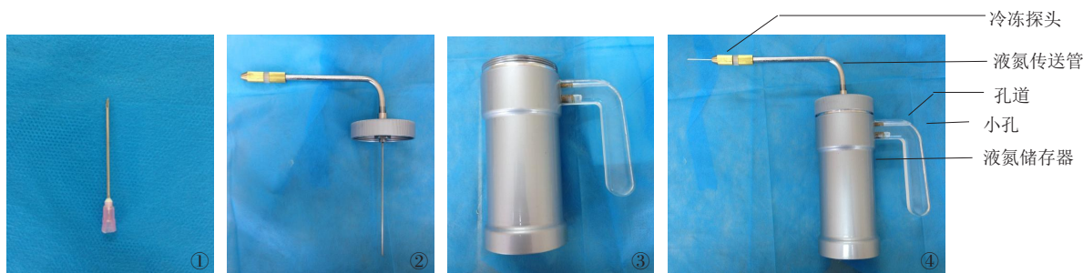
图1~4 液氮冷冻仪拆解及整体图。图1 冷冻探头;图2 液氮传送管;图3 液氮储存器;图4 整体观及工作原理图
