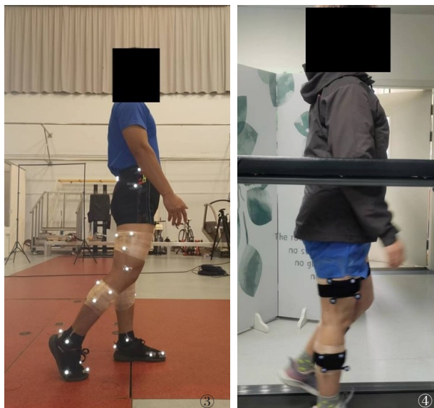
图3 使用生物力学实验室光学运动捕捉设备进行数据采集 图4 使用便携式红外光学运动捕捉设备进行数据采集
